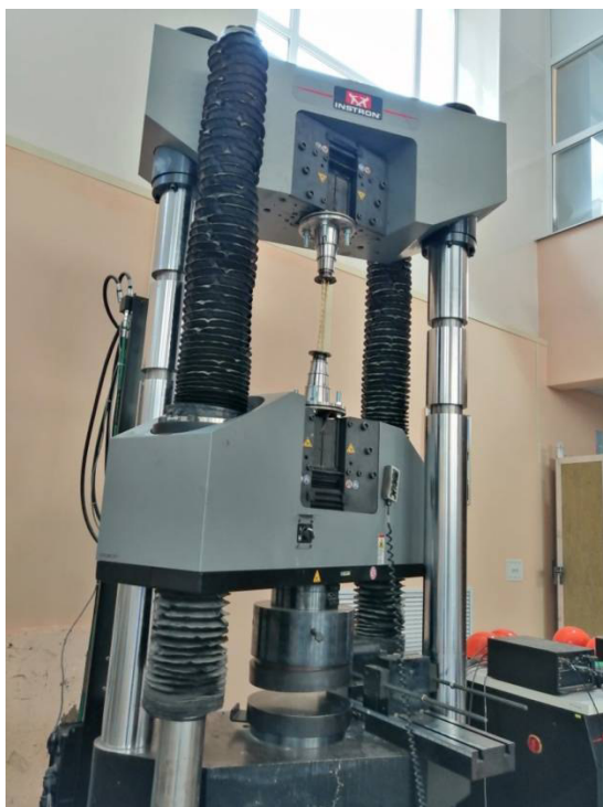
Рис. 11. Испытания анкерного захватного устройства для композитной арматуры при растяжении
