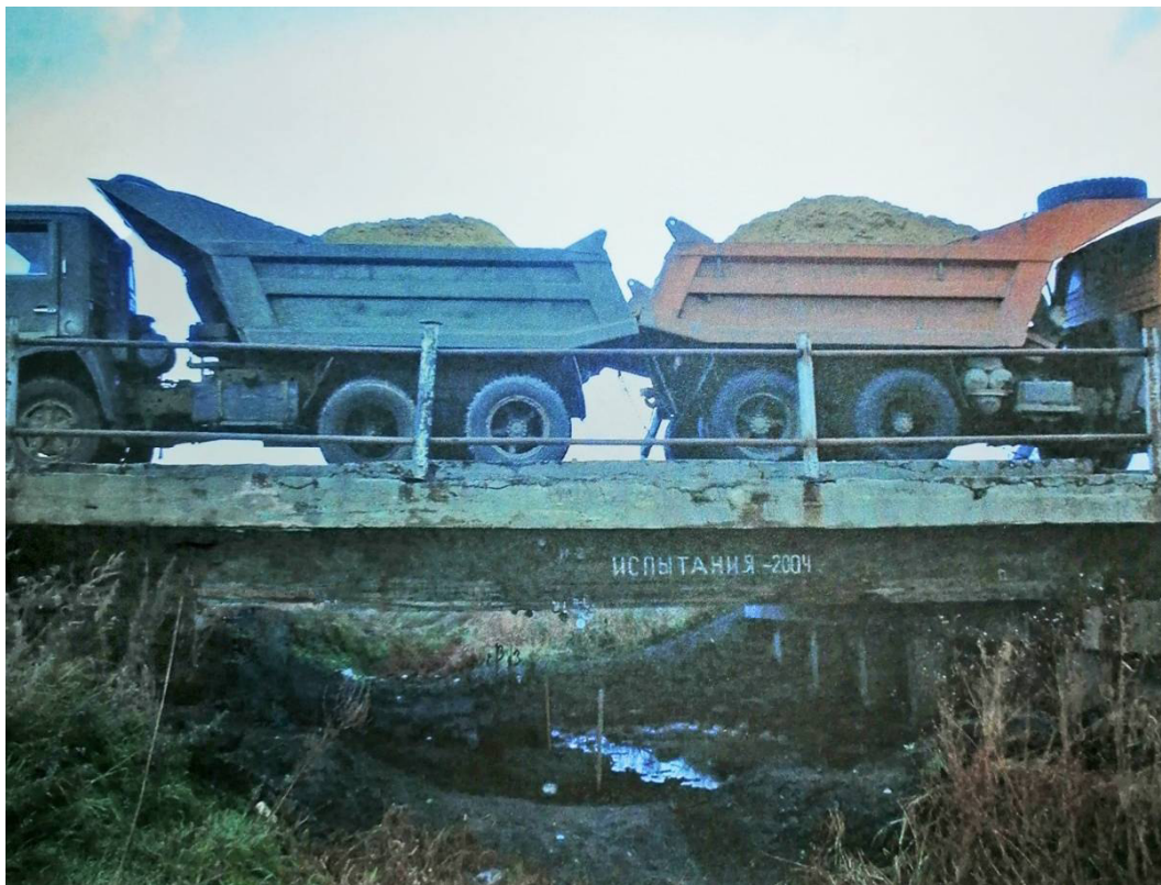
Рис. 5. Испытания моста в 2004 году
