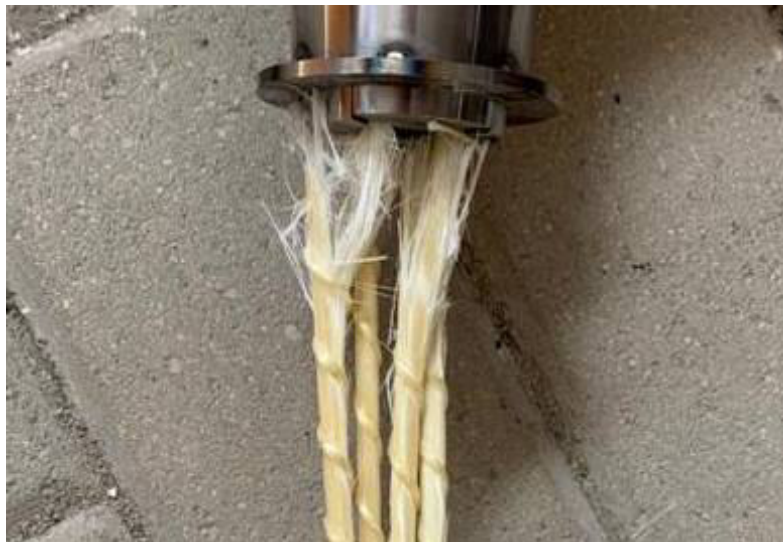
Рис. 13. Характер разрушения стеклопластиковой арматуры в захватном устройстве
